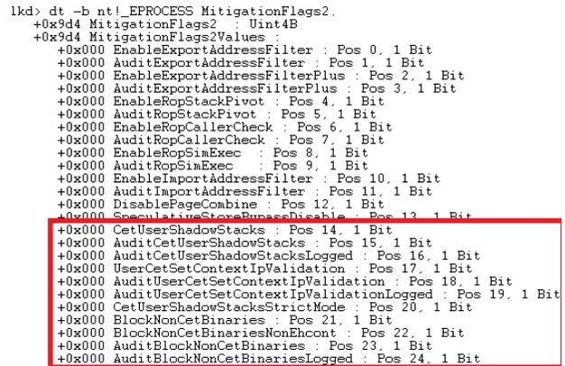
図 3-2 EPROCESS 構造体のメンバー MitigationFlags2 の各ビットのうち、Intel CET による緩和技術に関するフラグのみを赤枠で囲んで示した図
